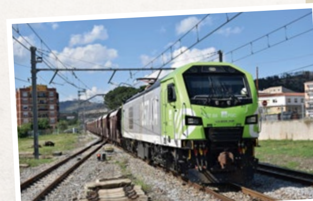
Tren de mercancías encabezado por una de las nuevas y modernas locomotoras duales, diésel y eléctrica, de la serie 257 en la estación de Sant Vicenç. Foto Joan C. Salmerón (2024).
