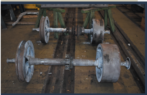
Les rodes del Funicular de Gelida, amb el sistema de doble pestanya que permet simplificar els creuaments. Foto Joan C. Salmerón (2017).
