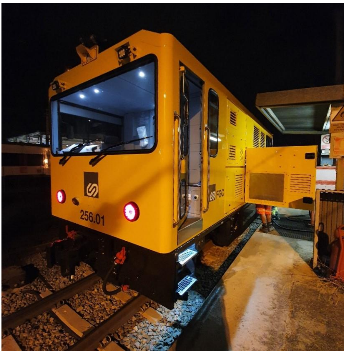
La locomotora és dual (alimentació elèctrica o dièsel) i mixta (tracció en adherència i en cremallera).
