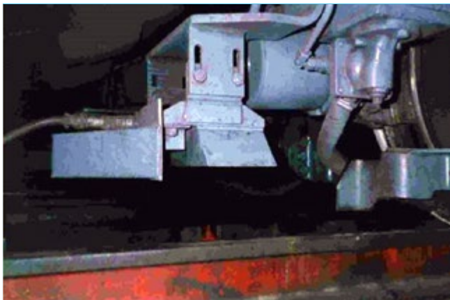
Antena de l'ATP instal·lada al bogi.
