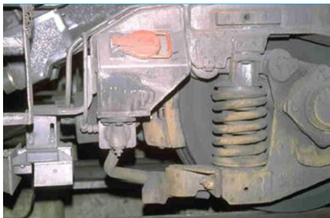
Suspensió primària d'una unitat de tren.
