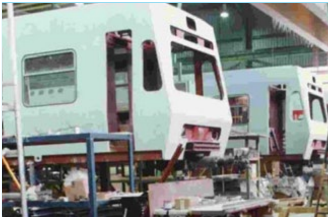
Bastidor autoportant d'unitat de tren.
