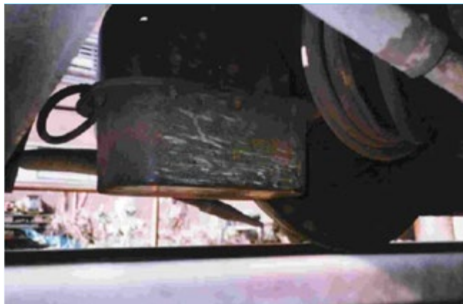
Captador de FAP al bogi d'un tren.
