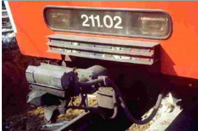
Unitat de tren dotada d'enganxall automàtic BSI.
