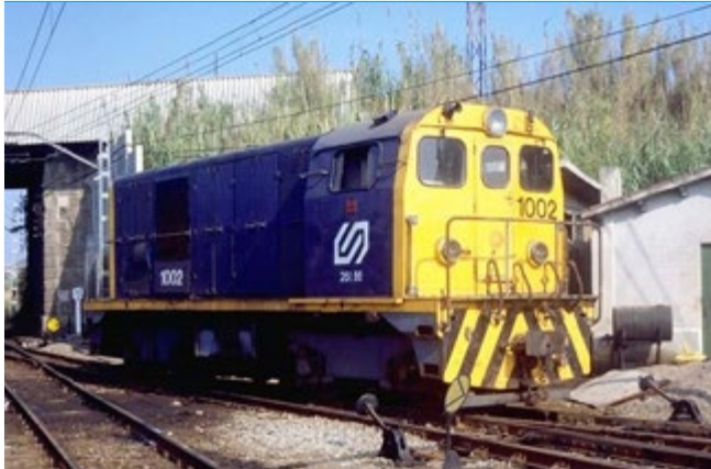
Locomotora dièsel amb transmissió elèctrica.
