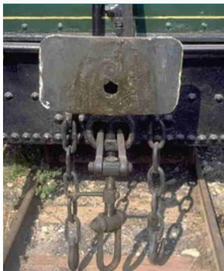
Enganxall manual de topall i brida.
