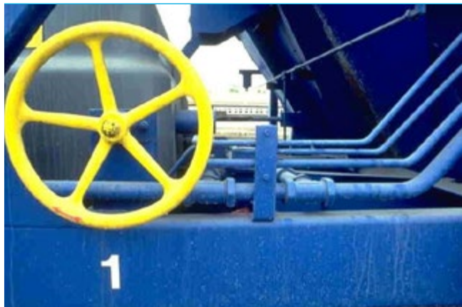
Volant de fre d'estacionament manual.
