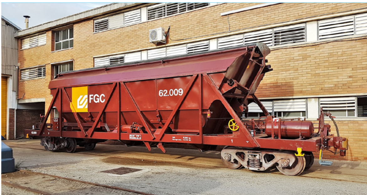
Vagó de Ferrocarrils de la Generalitat de Catalunya, de la línia Llobregat - Anoia, sobre dos bogis.
